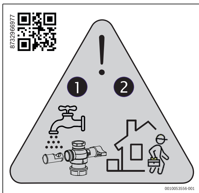
Afb. 34 Deeltjesfilter na de inbedrijfname en het onderhoud reinigen
