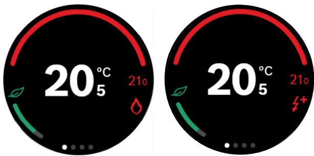
Ketel of stadsverwarming in cv-bedrijfstellen
